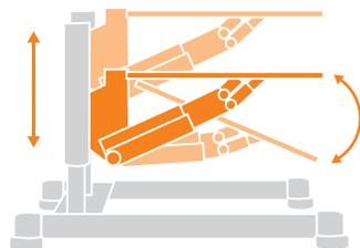
Todos los reposapiés de bimos disponen de una regulación continua de altura y del ángulo de inclinación. De este modo, los reposapiés se puede adaptar perfectamente a cada situación de trabajo. En el modelo 945 una amortiguación a gas refuerza este procedimiento haciendo igual de cómoda la regulación de los reposapiés que el resto de los mecanismos de la silla.
