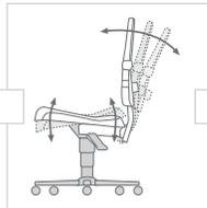
Respaldo de contacto permanente con regulación de inclinación de asiento
